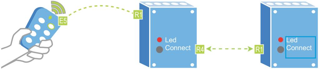
On peut utiliser plusieurs MTV300MRP pour augmenter la puissance. Chaque produit doit commander individuellement 300W maximum. On peut ensuite relier par radio leur fonctionnement. Les variateurs fonctionnent en même temps.
