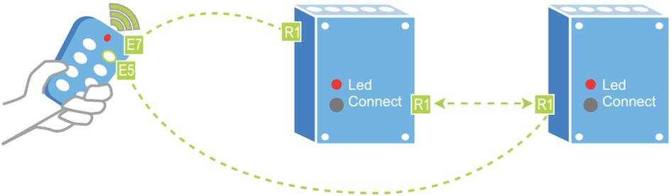
A l'exception des MTV500ERP, tous les modules récepteurs radio YOKIS nécessitent l'utilisation d'un outil fin et convenablement isolé pour atteindre le bouton "connect"
